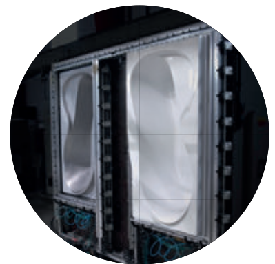
Die RAVAK-Presserei Hier entsteht unter Einsatz unserer innovativen Punkterwärmungstechnologie ein Acryl-Pressling für eine Badewanne.
