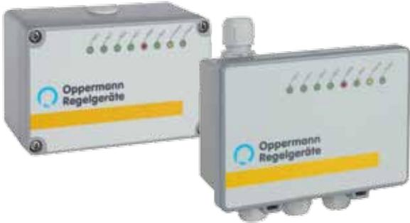
Das Klappenmodul kann die beiden Endlagen der BSK / RSK erfassen (2 Wechslergänge) und diese über Bus-Protokoll (BACnet oder Modbus) an die DDC schicken. Für Servicezwecke kann das Modul an Klemme 9 + 10 des KRM angeschlossen werden und eine Testauslösung erzeugen, welche von der DDC per Feldbus an das Modul gesendet wird.
