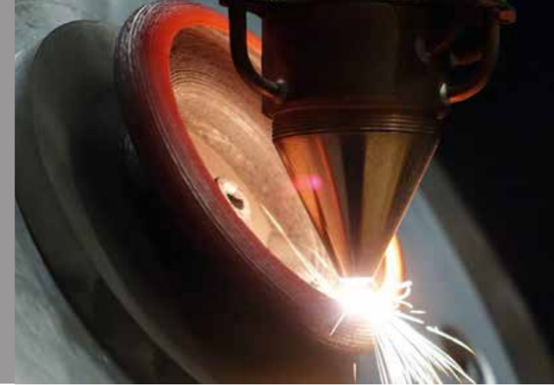
Roboterbasierte Additive Fertigung mit Laser Material Deposition.
