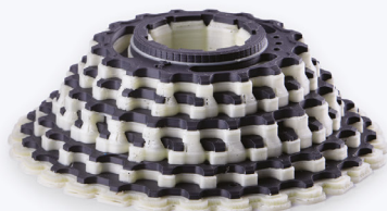
Modell eines Fahrradzahnkranzes vor dem Auflösen des Stützmaterials
