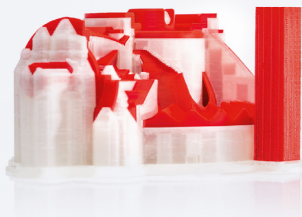
Modell des Getriebes vor der Auflösung des Stützmaterials
