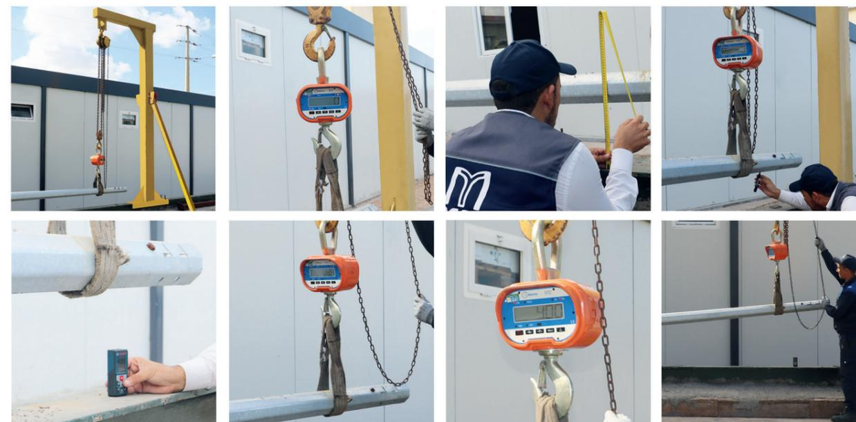
**OBJET :** Décrire le processus de vérification de la charge utile maximale et du déplacement au sommet des mâts utilisés dans la distribution électrique.
