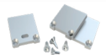
Kit tappi anodizzati argento o verniciati per copertura LHCOP0101 . Il kit comprende 2 tappi chiusi + 1 con foro, e 4 viti autofilettanti in inox 2,2x 6,5 mm.
