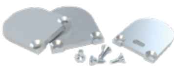
Kit tappi anodizzati argento o verniciati per copertura LHCOP0105 . Il kit comprende 2 tappi chiusi + 1 con foro, e 4 viti autofilettanti in inox 2,2x 6,5 mm.
