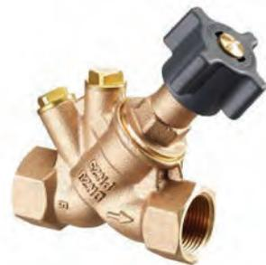
Die Strangabsperrentile werden in Strangleitungen von Warmwasser-Zentralheizungsanlagen und Kühlanlagen eingebaut und ermöglichen das Absperrn der Strangleitungen. Die Strangabsperrentile besitzen 2 mit Blindstopfen verschlossene Anschlussbohrungen in die F+E-Kugelhähne (Zubehör) eingeschraubt werden können. Der Einsatz der Strangabsperrentile ist sowohl im Vorlauf als auch im Rücklauf möglich. Die Isolierschale ist für die Vorlauftemperatur bis 6°C geeignet.
