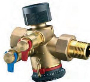
Das kombinierte Regel- und Regulierventil mit automatischer, differenzdruckunabhängiger Durchflussregelung ist eine Ventilkombination. Sie besteht aus einem Durchflussregler, dessen Sollwert mittels eines frei zugänglichen Handrades eingestellt wird, und einem Regulierventil. Das Regulierventil kann mit einem Stellantrieb, einem Temperaturregler oder einem Handregulierkopf ausgestattet werden (Gewindeanschluss M 30 x 1,5). Die Isolierschale ist für die Vorlauftemperatur bis 6°C geeignet.
