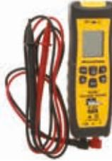
Spannungs-/Durchgangsprüfer mit LCD, FI-Schalter, Taschenlampe, NCV CAT IV 600V
