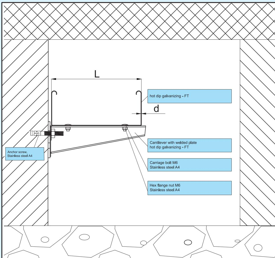
PRIKAZ MONTAŽE NOSAČA KABLOVA U TUNELSKOM KANALU
