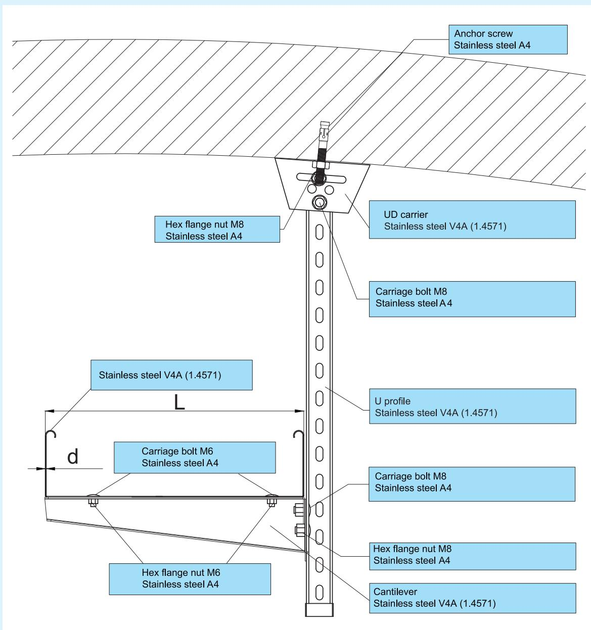
**PRIKAZ MONTAŽE NOSAČA KABLOVA NA CEV TUNELA
