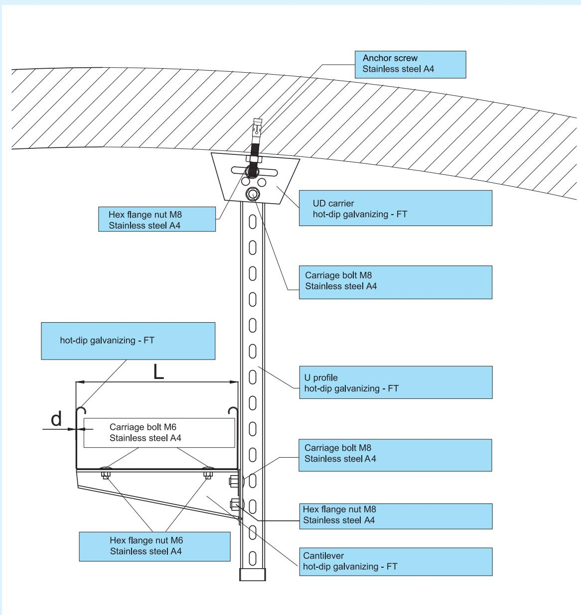
PRIKAZ MONTAŽE NOSAČA KABLOVA NA CEV TUNELA
