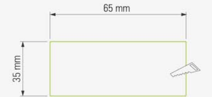
TAVAN KESİM ÖLÇÜSÜ CEILING CUT-OUT SIZE
