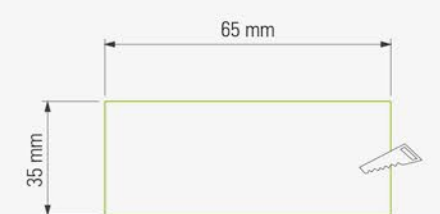
TAVAN KESİM ÖLÇÜSÜ CEILING CUT-OUT SIZE
