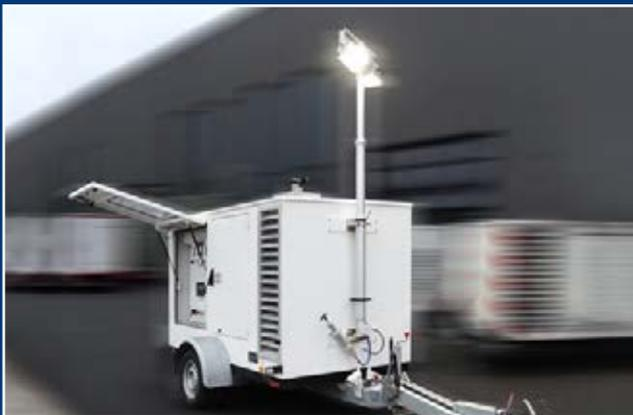
Optional mit 5 m pneumatischen Lichtmast und 2 × 180 W LED Scheinwerfern.
