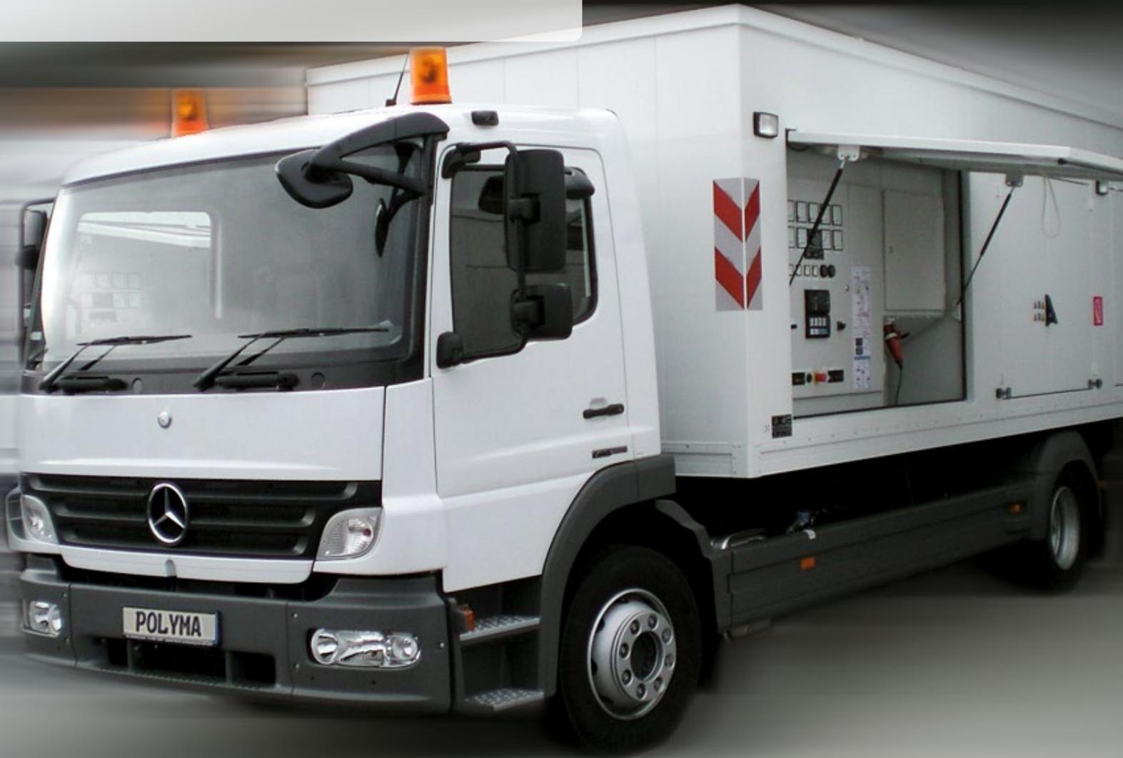
Die mobilen Aggregate sind immer auf den konkreten Einsatzzweck zugeschnitten: beispielsweise automatische Stationsfreischaltung, Pumpenbetrieb, Spitzenlast und/oder Notstrom.
