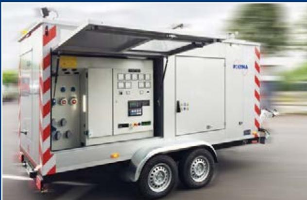
Wie bei allen POLYMA Tandemaggregaten ist der Schaltschrank bedienungssicher im Verkehrsschatten in Fahrtrichtung rechts.
