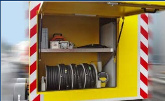
Heckseitig ist die 24-V-Kabeltrommel und eine praktische Stauablage angeordnet.
