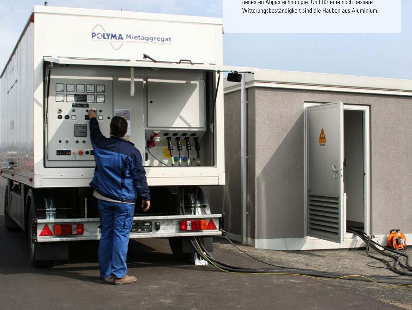
Die mobilen Aggregate sind immer auf den konkreten Einsatzzweck zugeschnitten: beispielsweise automatische Stationsfreischaltung, Pumpenbetrieb, Spitzenlast und/oder Notstrom.
