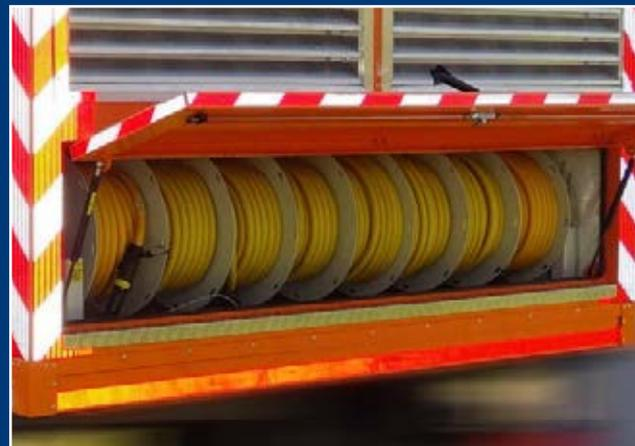
Die Kabeltrommelanlage befindet sich heckseitig unter der Abluft. Verfügbar für bis zu 16 Leitungen 95 mm<sup>2</sup> mit jeweils 25 m.
