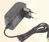
Model: A-36-12/A-36-24 Power(功率) : 36W Output(输出) : 12V3A(W)/24V1.5A(W) Size(尺寸) : 93.5mm*43.5mm*33mm
