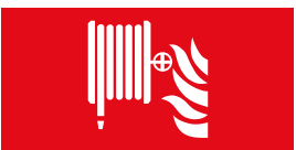
HYDRANT WEWNĘTRZNY / FIRE HOSE REEL
