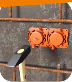
Frontteil auf Schalung nageln. Das Frontteil lässt sich durch das Stecksystem fest mit weiteren Krümmern und auch Tüllen verbinden. Krümmer auf das Frontteil stecken. Idealer Biegeradius von 30°.
