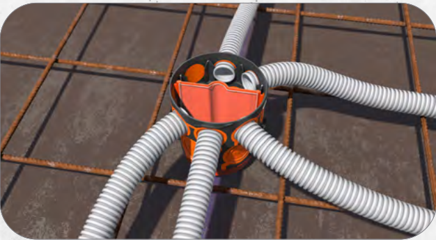
3. Kabel oder (starre) Rohre bis M40 werkzeuglos einführen. Sichere Zugentlastung durch Rohrgrip. Optionaler Trennsteg für zwei getrennte Stromkreise in einer Dose.
