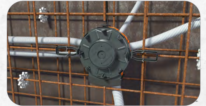
2. Membrane mit einem Cuttermesser öffnen. Werkzeuglose Kombieführung von Kabeln und (starrten) Rohren von M9-M40. Die Membrantechnik gewährt eine absolut betondichte Einführung.
