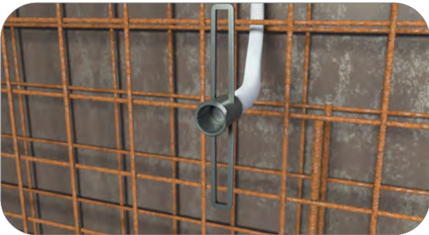
Tülle mit Flügeln direkt an Stahlarmierung befestigen oder mit Boden an Schalung nageln. Nach der Betonage einfach mit einem Schraubenzieher öffnen.
