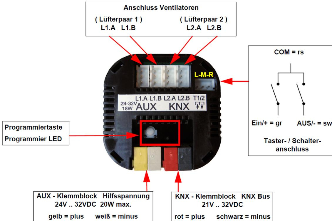
Die KNX-Klemme wird über den mitgelieferten Klemmenblock ( rot (+) / schwarz (GND) ) mit dem KNX-Bus verbunden. Die Hilfsspannung wird über den mitgelieferten Klemmenblock ( gelb (+) / weiß (GND) ) aufgeschaltet. Die Lüfter werden gemäß Lunos-Spezifikation montiert und über die mitgelieferten vorkonfektionierten Steckverbinder angeschlossen. Optional können potenzialfreie Taster- / Schalter über die mitgelieferten vorkonfektionierten Steckverbinder angeschlossen werden.
