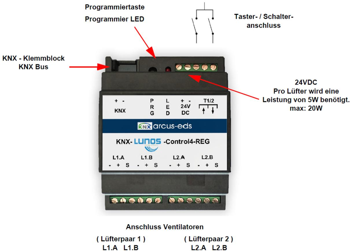
Die KNX-Klemme wird über den mitgelieferten Klemmenblock ( rot (+) / schwarz (GND) ) mit dem KNX-Bus verbunden. Die Hilfsspannung wird über eine Schraubklemme angeschlossen. Die Lüfter werden gemäß Lunos-Spezifikation montiert und über die Schraubklemmen angeschlossen. Optional können potenzialfreie Taster- / Schalter ebenfalls über Schraubklemmen angeschlossen werden.
