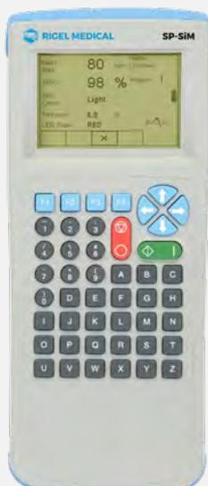
Rigel SP-SiM, ein mobiler Hochleistungspuls-oximetriesimulator für die schnelle, genaue und effiziente Prüfung von SpO2-Geräten, nutzt eine neue Technologie, um die Unsicherheiten zu beseitigen, die bei der Prüfung mit traditionellen Methoden wie dem optischen Finger oft auftreten können.
