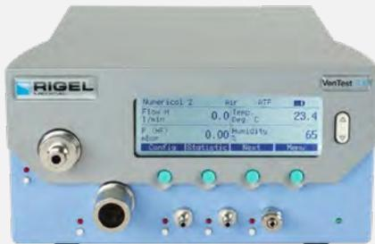
Der Rigel VenTest 800 Gasdurchflussanalysator ist ideal für die Prüfung aller gängigen Beatmungsgeräte sowohl auf dem Prüfstand als auch im Außendienst geeignet, um sicherzustellen, dass die kontinuierliche Genauigkeit und Zuverlässigkeit der Geräte innerhalb der erforderlichen Leistungsstandards bleibt.
