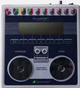
Der multimode Defibrillator-Analysator SECULIFE DF PRO ist ein intelligentes Gerät, das für die Prüfung von Defibrillatoren neuester Generation eingesetzt wird. Es misst die abgegebene Energie und liefert Informationen über den Puls. Der gemessene Puls kann auch grafisch angezeigt werden. Der Tester ist für die Prüfung von manuellen, halbautomatischen und automatischen Defibrillatoren mit **monophasischer, biphasischer sowie biphasisch gepulster Abgabe geeignet**.
