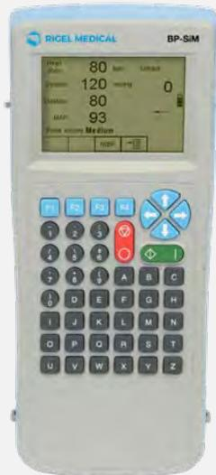
Der Rigel BP-SiM ist ein tragbarer NIBP-Simulator, der alle Leistungsmerkmale mit einem internen Speicher mit großer Kapazität für die Datenerfassung kombiniert.
