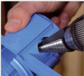
**1** Rohrlöcher ausbohren.
