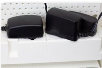
**1** Auf den Kunststofftrageplatten werden die Hardware-Komponenten potentialfrei befestigt und über die Dreifachsteckdose für Euro-Stecker mit Netzspannung versorgt.
