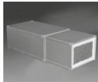
Kabelabschottungen WD90 und EasyFoam liefern wir in einer Standardlänge von 270 mm. Werden die Boxen in Wände oder Decken eingebaut, deren Dicke dieses Maß überschreitet, kann der Schottkasten mit Hilfe eines Verlängerungssatzes teleskopartig auf entsprechende Bauteildicke erweitert werden. So entsteht ein leicht zugänglicher Installationskanal, dessen Ende bündig mit der Wand oder der Decke abschließt. Verlängerungen können passend zu den jeweiligen Außenmaßen der Kabelboxen bestellt werden.
