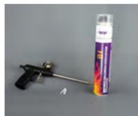
1K-Polyurethanschaum für rauchdichte Abdichtungen und Füllungen. Der Schaum entspricht der Brennbarkeitsklasse B1 (schwer entflammbar) und ist für den Einbau unserer EasyFoam- Kabelboxen zugelassen. Einfach den Spalt zwischen Wandöffnung und Kabelbox ausschäumen. Die Verarbeitung erfolgt in Verbindung mit einer entsprechenden Pistole. Der EasyFoam Brandschutzmontageschaum B1 kann auch zur Abdichtung der EasyFoam-
