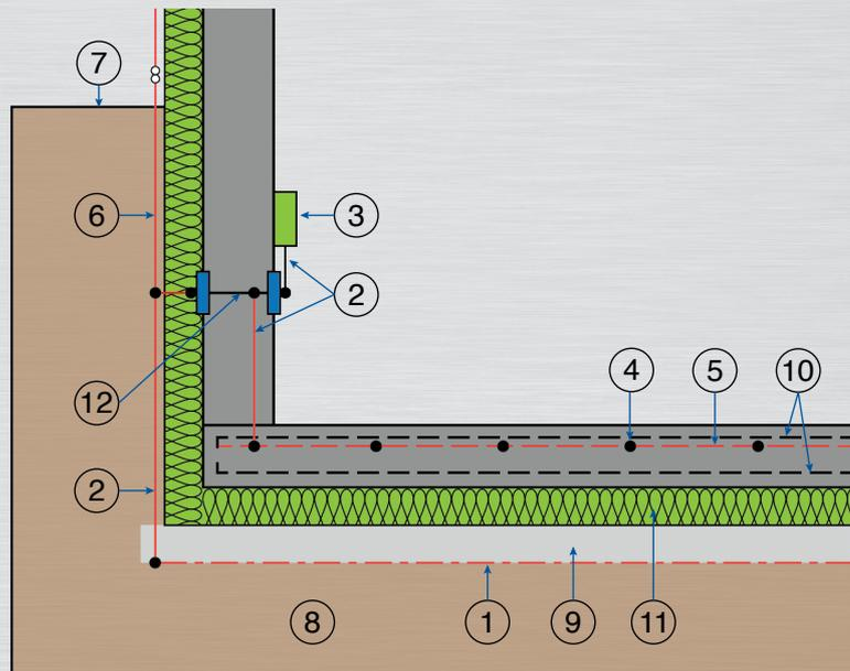
Bild 7: Ringerder und kombinierte Potentialausgleichsanlage bei Wärmedämmung (Perimeterdämmung) auf der Unterseite und/oder den Seitenwänden der Fundamente - druckwasserfeste Ausführung
