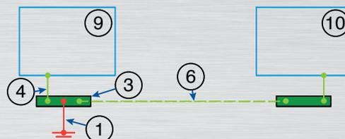
Bild 5: Separat geführter niederohmiger Potentialausgleichsleiter
