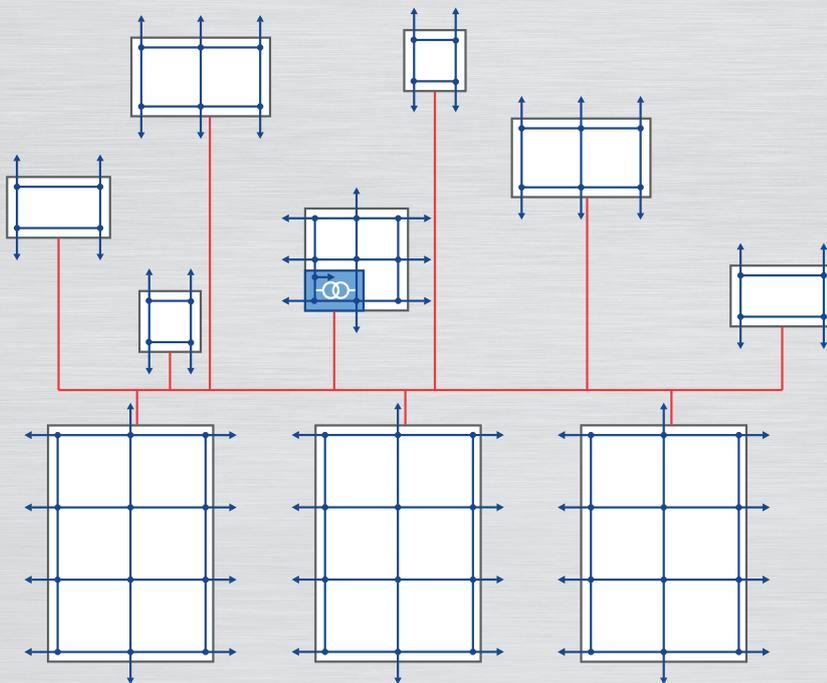
mit den jeweiligen Erdungsanlagen der Gebäude entsteht ein vermaschtes globales Erdungssystem. Dieses globale Erdungssystem stellt sicher, dass keine gefährlichen Berührungsspannungen am PEN-Leiter auftreten können und ist somit auch die Grundlage dafür, dass in Deutschland der Neutralleiter im Fehlerfall nicht abgeschaltet werden muss.
