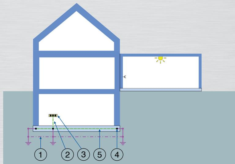
Bild 14: Teilunterkellertes Gebäude ohne Erdungsanlage im Nebengebäude
