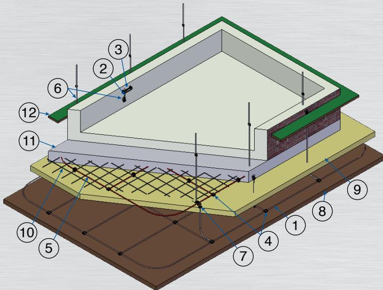
Bild 6: Ringerder: Räumliche Anordnung - Ringerder und kombinierte Potentialausgleichsanlage
