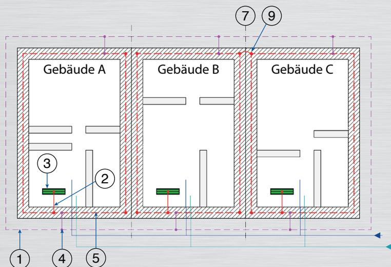
Bild 16: Anordnung eines Ringerders in Reihen-/Doppelhäusern
