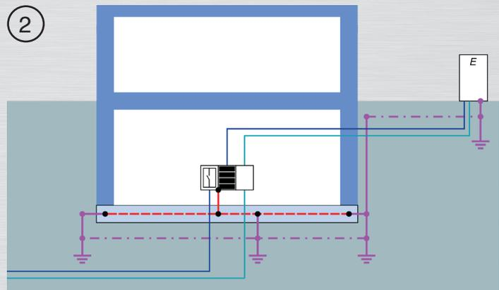
Bild 19: Ladeeinrichtung aus Gebäude versorgt
