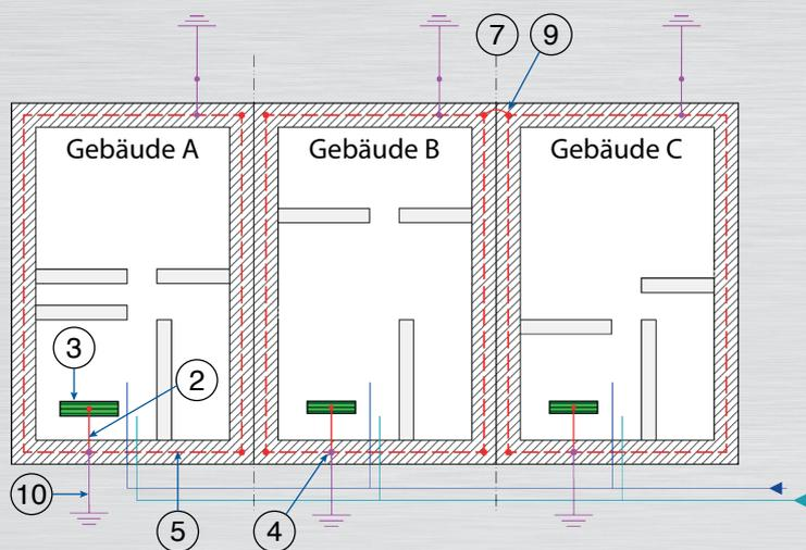
Bild 17: Anordnung von Stab-/Tiefen-/Strahlenerdern in Reihen-/Doppelhäusern
