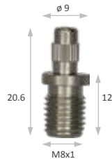
CODE : GPCB-216 WIRE : \phi 1-1.2mm
