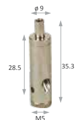
CODE : GPCB-219F WIRE : \phi 1.2-1.5mm
