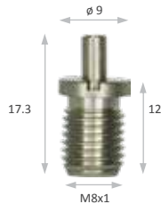
CODE : GPCB-211 WIRE : \phi 1-1.2mm
