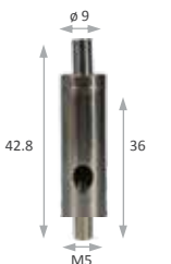
CODE : GPCB-337 WIRE : \phi 1.2-1.5mm
