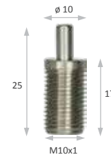
CODE : GPCB-214 WIRE : \phi 1.2-1.5mm
