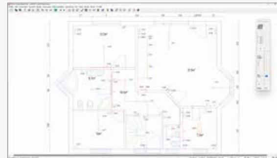
Mit Treesoft CAD Gebäudetechnik können Sie Grundrisse selber zeichnen oder mit dem Treesoft CAD Konverter aus einer PDF/DXF/DWG-Datei importieren. Die Elektroinstallation erstellen Sie durch das Einsetzen von Leistungen. Die Positionsliste mit Mengenangaben und Einheit sowie der Verteilerplan werden automatisch generiert.
