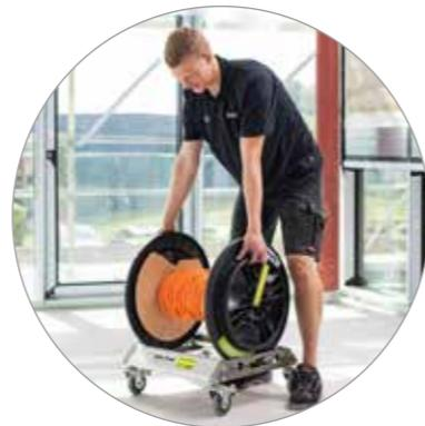
Legen Sie je ein CONTOUR-Rad auf die Außenseite der aufgestellten Kabeltrommel. Legen Sie nun den Hebel um, dadurch wird der Innen-Spannkern aktiviert und das CONTOUR-Rad sitzt fest auf der Trommel.
