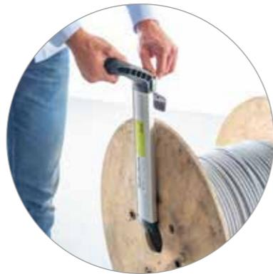
Lösen Sie den Klemmhebel und führen Sie die Klemmeinheit bis zum Rand der Kabeltrommel.
