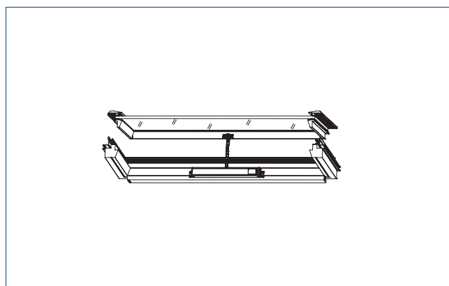
Dachflügel Rahmenmontage AUSWÄRTS öffnend
