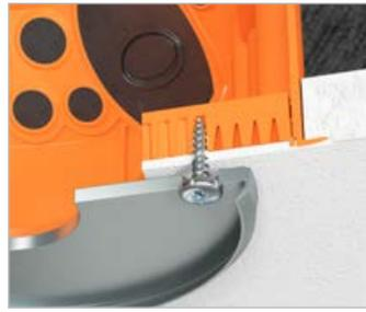
Bei der Gerätebefestigung verwenden Sie nur Schrauben, die in, aber **nicht** durch die Anschraubfläche reichen (z.B. Schraube mit Halb-Rundkopf 3,5 x 15 mm)!
