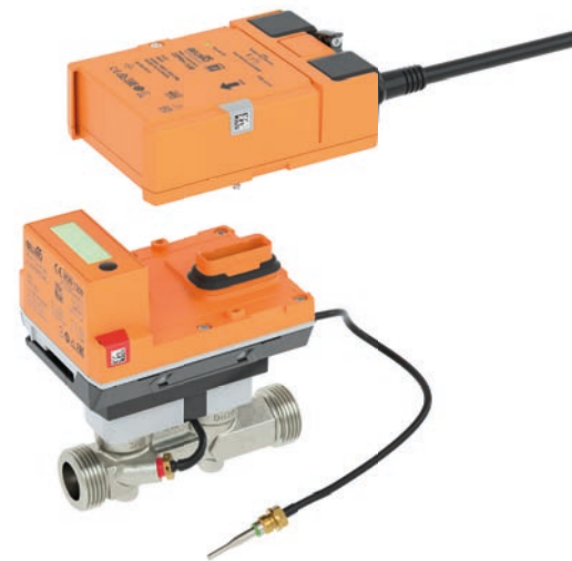
Abb. 40: Die gesamte Verdrahtung ist mit dem Logikmodul verbunden, sodass das Sensormodul EN 1434/MID neu kalibriert werden kann, ohne die Verdrahtung zu lösen.
