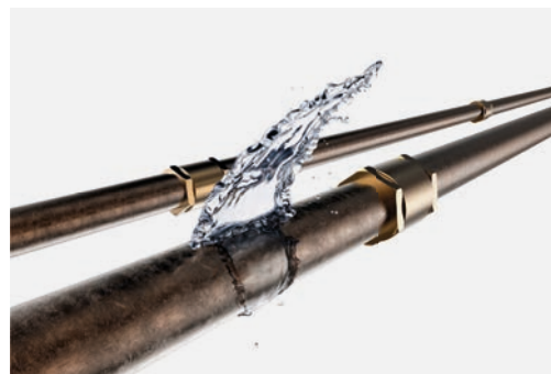
Abb. 123: Die Angst vor einem Versagen der Rohrleitungen ist häufig der Grund für die Überdosierung von Glykol und den daraus resultierenden erhöhten Energieverbrauch der Pumpen.
