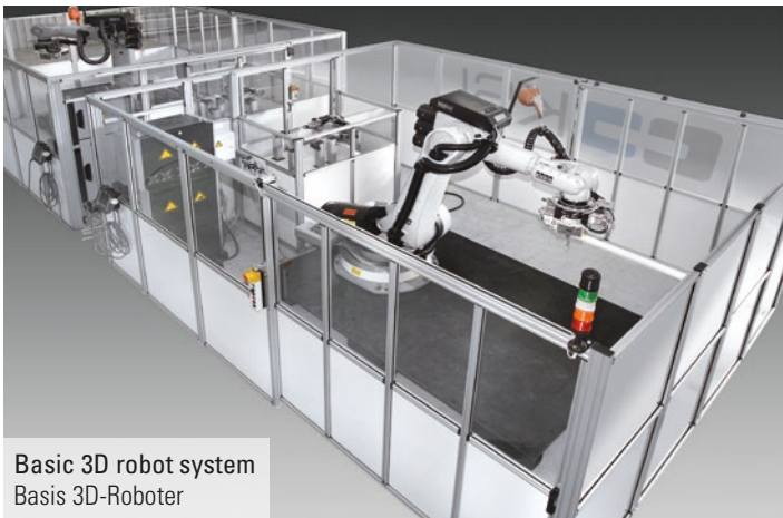
Robot system with linear axes 3D-Roboter mit Linearachsen
