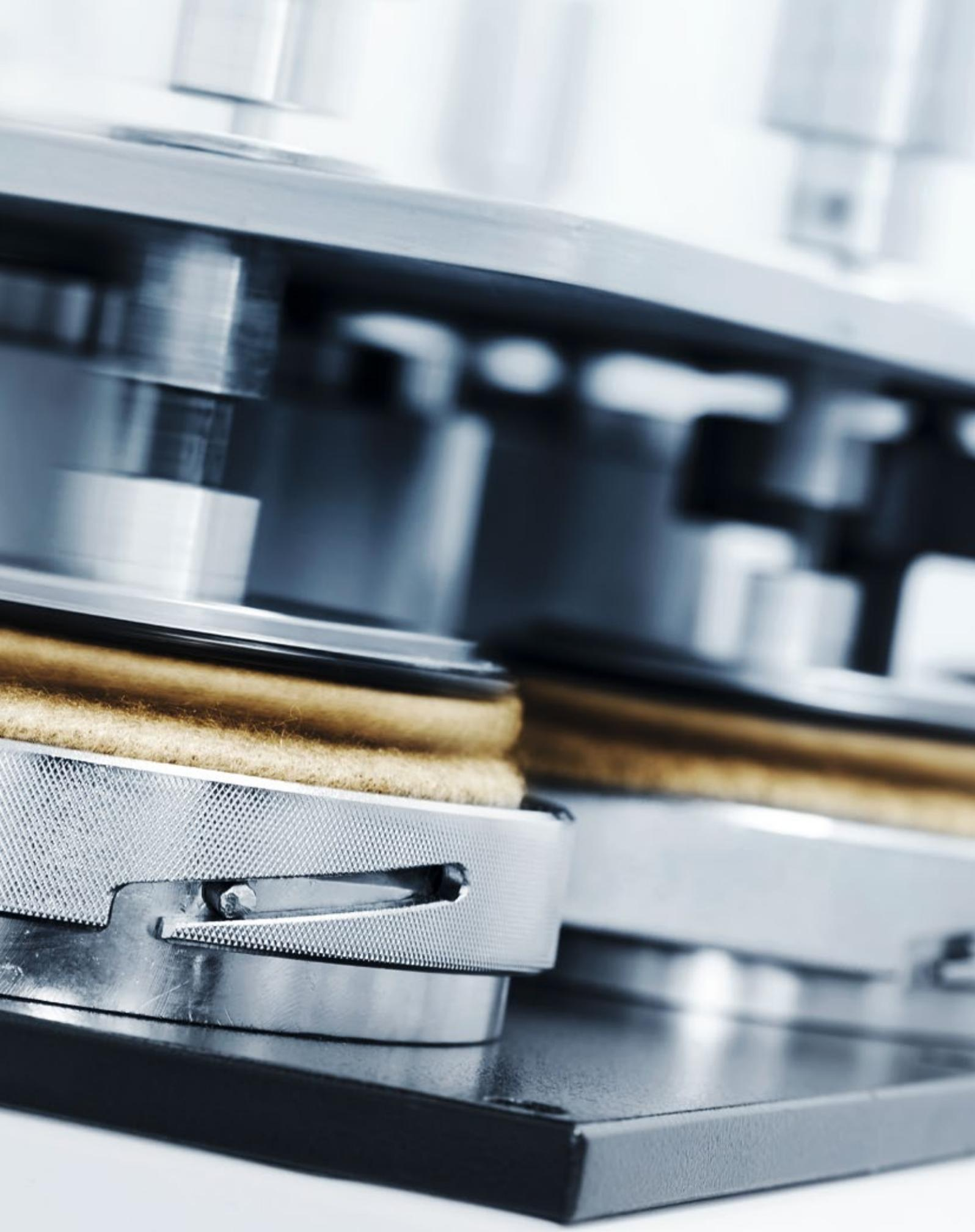
Am **Martindale Testgerät** wird die Scheuerfestigkeit des Materials geprüft.
