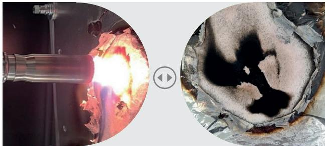
Prüfung der Feuerbeständigkeit – Metallbauweise
