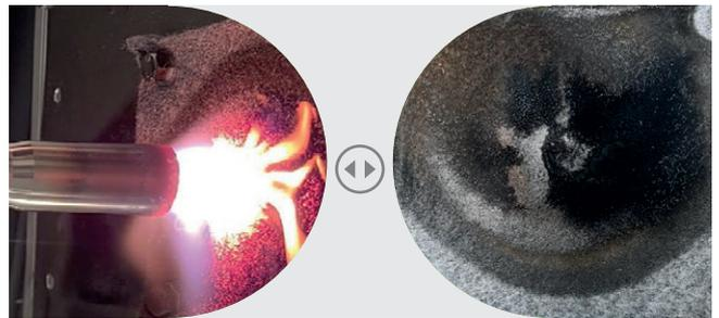
Prüfung der Feuerbeständigkeit – Vliesstoffstruktur
