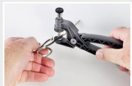
Zange zum Einstellen der Spannschraube M/111.41
