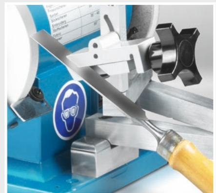
Spannvorrichtung für Stechbeitel M/111.40
