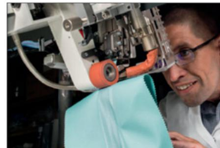
Zuverlässige Dichtheit auch an den Nähten durch kompatible Topaz Tapes Nahtabdichtungs-bänder.
