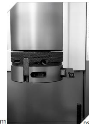
Silindiri merkezledikten sonra, rektefiye edebilirsiniz After centering the cylinder, you can bore the inside of cylinder.
