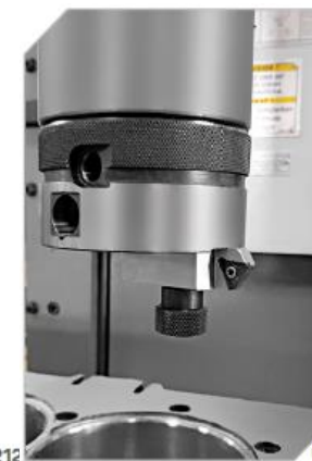
Havşa kalemi, silindir ağızına havşa açmanızı sağlar. Chamfering a cylinder with the chamfering tool.
