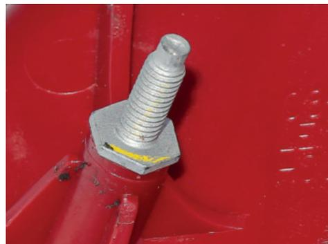
Die fehlende Vulkanfiberscheibe kann Korrosion am Fahrzeug verursachen. Der nicht konische Gewindekopf erschwert den Einbau der Leuchte in das Fahrzeug.
