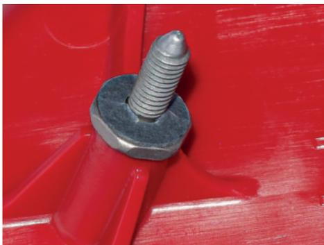
Die Vulkanfiberscheibe schützt das Fahrzeug vor Korrosion. Der Einbau wird dank konischem Gewindekopf erleichtert.
