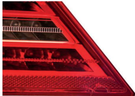
Nach Durchführung der Spannungsrisstprüfung weist die Lichtscheibe der Kopierleuchte zahlreiche Risse auf und löst sich an einigen Stellen vollständig vom Gehäuse.
