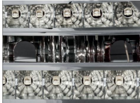
Einfallstellen und Deformationen der Reflektionsflächen verhindern die perfekte Lichtverteilung. Nicht alle LEDs sind im Brennpunkt des Reflektors positioniert. Die gesetzlich vorgeschriebenen Lichtwerte werden nicht erfüllt.
