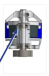
Patentierte Motor/Lagerkonstruktion mit einseitig vorgespanntem Doppellager und zweiteiliger Welle für hohe mechanische Belastung, ruhigen Lauf und präzises Schleifen.
