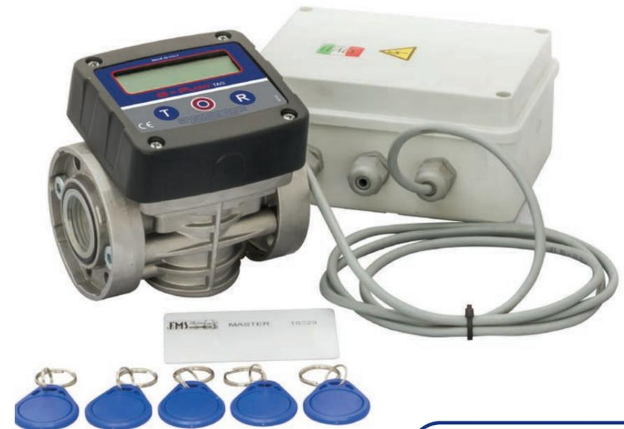
Die Autorisierung erfolgt durch den Inhaber der Anlage (MASTER), der bis zu 50 Nutzerschlüssel (TAG) programmieren und für jeden Nutzer Begrenzungen für jede Betankung und eine Gesamtmenge von verfügbaren Litern in einem bestimmten Zeitraum einstellen kann. Mithilfe des Geräts können die an jeden autorisierten Nutzer im abgefragten Zeitraum abgegebenen Gesamtmengen unmittelbar eingesehen und diese Daten mit dem „Daten-Download Kit“ (optional) auf den Computer übertragen werden.
