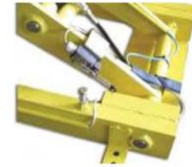
Stoppeinrichtung für endgültiges Senken mit akustischem Signal
