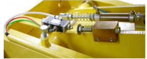
Stoppeinrichtung für endgültiges Senken mit akustischem Signal (an JO.30JP und JO.35)
