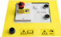
Notausknopf mit Schlüssel gegen unbefugte Benutzung
