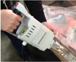
**QUICK PULLER** ein tragbarer Ausbeulspotter mit Griff als Schlaghammer, geringem Gewicht und die Masse ist direkt an dem Gerät neben der Ausbeulspitze. Sofort einsatzbereit und verkürzt die Reparaturzeiten deutlich.
