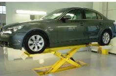
Verschiedene Modelle, Über- und Unterflur, nur als Hebebühne oder als Richtanlage sind lieferbar. Von 3.000 Kg – 5.000 Kg Tragkraft
