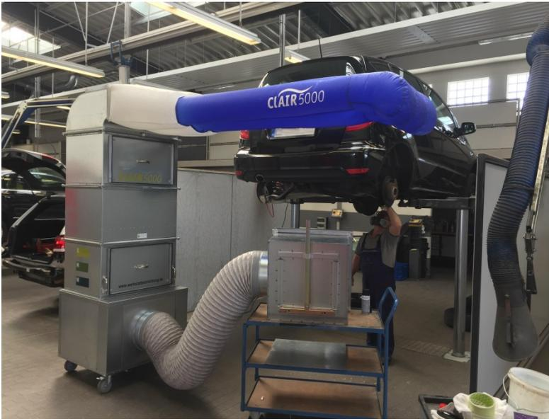
mit Trichter auf Fahrwagen platziert, z.B. zum Spritzen von Unterbodenschutz
