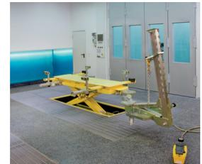
Jollift & Bench Richtanlagen sind in verschiedenen Ausstattungen lieferbar: Überflur oder Unterflur mit Platten zum Heben an Rädern sowie verschiedene Fahrzeugaufnahmen und unterschiedliche Zuggräte.
