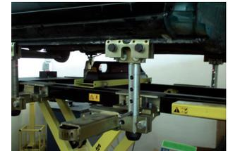
Jollift Flex (Unterflur) komplett mit Zuggerät BT 10T (10 Tonnen effektive Zugkraft an der Kette) Plattformen zum Heben an Rädern, Spannklemmen FL 03, Schwenkarme mit Gummiauflagen.
