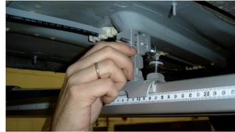
Anschrauben der Messschienen
