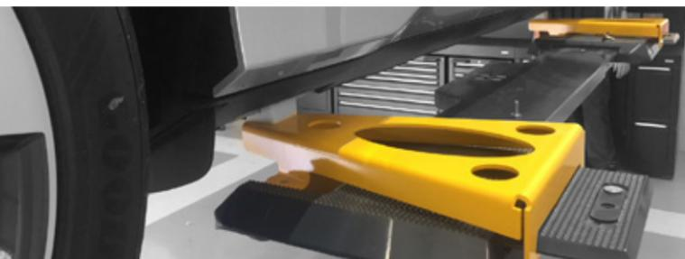
Die Masterlift 2.35 Pv 180-240 mit Kolbenabstand (KA) 1700 kann die derzeit gängigsten Elektrofahrzeug-Modelle sicher anheben.
