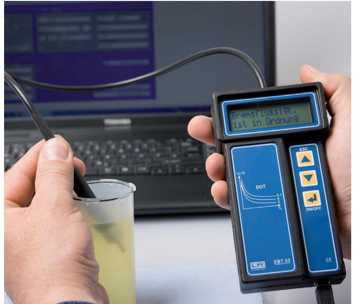
**LR** Prüfprotokoll Bremsflüssigkeitstest / Brake fluid test protocol
