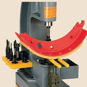
Durch die Backenführung wird der Bremsbacken beim Nieten und Entnieten in der richtigen Lage gehalten, so dass er nicht verkanten kann.
