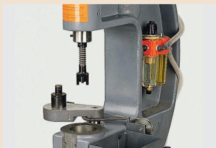
Eine Schwenkeinrichtung erleichtert das Einlegen von Doppelsteg-Backen.
