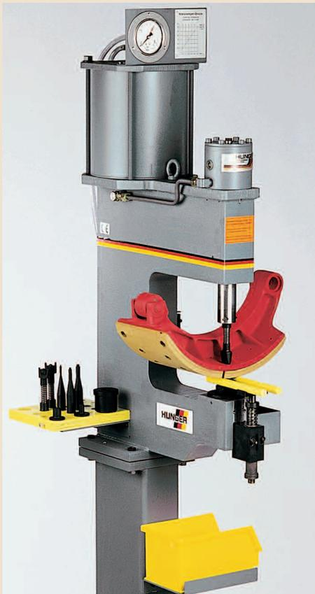
Die N 332/80-CE hat einen vergrößerten Gesamthub von 80 mm und eine Arbeitstiefe von 230 mm. Dadurch können vor allem Doppelstegbacken problemlos bearbeitet werden. Mit der größeren Arbeitstiefe müssen die Bremsbacken zum Benieten der hinteren Bohrungen **nicht** mehr umgedreht werden.
