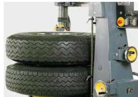
des Drehens. Mit der U 305 können auch Bremstrommeln mit komplett montierten Radsätzen bearbeitet werden. Dazu ist der lange Schwenkarm notwendig.
