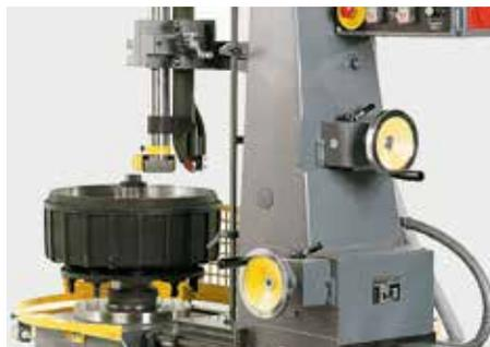
beispielsweise von oben nach unten vordrehen und von unten nach oben feindreihen. Natürlich kann man die Trommeln auch schleifen: Entweder im Anschluss oder gleichzeitig während
