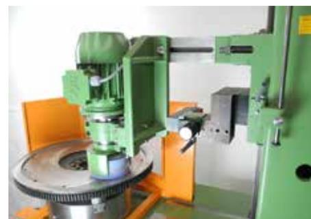
gespannt. Die Planschleifvorrichtung für Kreuzschliff wird mit einem speziellen Halter am langen Schwenkarm befestigt.
