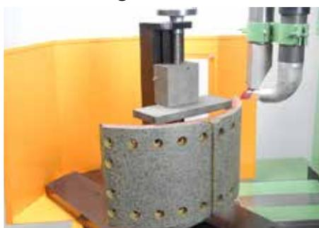
Die U 305 eignet sich auch zum Überdrehen von Bremsbelägen ebenso wie zum Plandrehen und Planschleifen von
