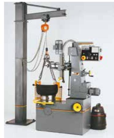
Zum Be- und Entladen der U 305 eignet sich der Säulenschwenkkran, der mit Elektro- oder Handkettenzug lieferbar ist.
