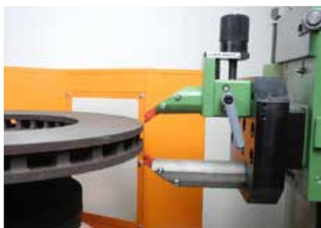
Bremsscheiben aller Größen werden mit dem Doppelstahlhalter gleichzeitig auf beiden Seiten feingedreht.
