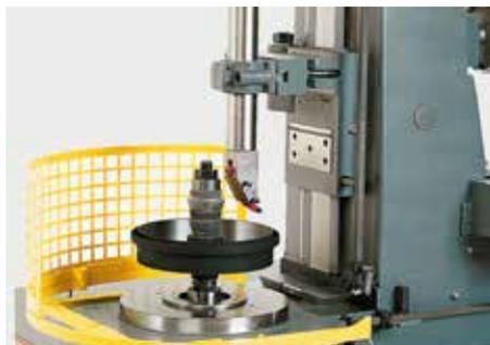
Im Normalfall werden Bremstrommeln nur ausgedreht. Dafür steht sowohl von oben nach unten als auch von unten nach oben ein automatischer Vorschub zur Verfügung. Man kann
