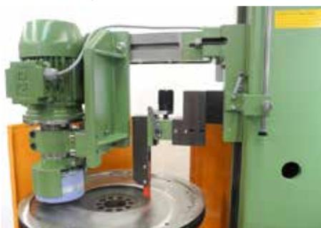
Kleine oder große Schwungscheiben planzdrehen oder planzuschleifen ist kein Problem. Die Werkstücke werden im Dreibackenfutter schnell und genau
