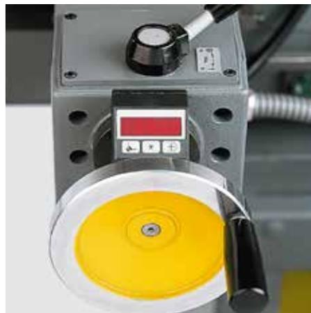
Zur schnellen und sicheren Einstellung von Trommeldurchmesser und Drehzahl können auf Wunsch LCD-Digitalanzeigen eingebaut werden.
