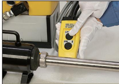
**5.** Halten Sie während der Rohraufweitung die Taste „UP“ (Hoch) solange gedrückt, bis der Motor stoppt. Halten Sie dann die Taste „DOWN“ (Niedrig) zwei Sekunden lang gedrückt, um den Druck abzulassen.
