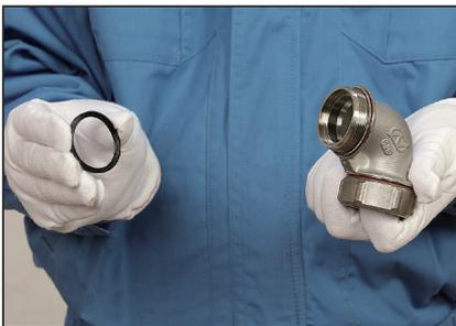
**7.** Sollte das Gummidichtungsmaterial abgefallen sein, müssen Sie auf jeden Fall wieder am Hauptteil des Anschlussstücks anbringen.
