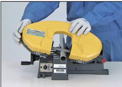
**1.** Schneiden Sie das Rohr unter Bezugnahme auf die Tabelle mit den Zuschnittmaßen für das Rohr mit einer Metallsäge oder Bandsäge in einem rechten Winkel zur Achsenmitte zu.
