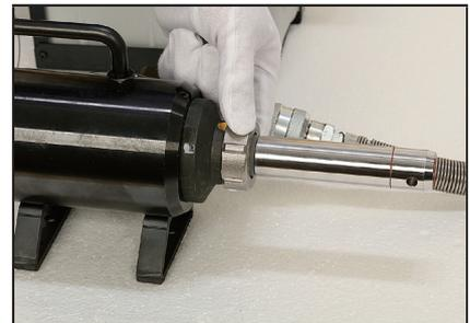
**3.** Ziehen Sie die Hutmutter am Bügel fest an.
