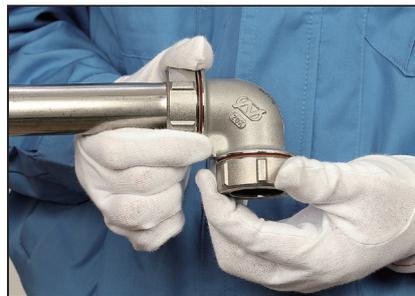
**8.** Bringen Sie die konische Unterlegscheibe in einem Abschnitt an, an dem die Seitenfläche der Hutmutter mit dem Anschlussstück in Kontakt steht, und ziehen Sie die Mutter soweit fest an, dass die farbige Fläche nicht mehr zu sehen ist.
