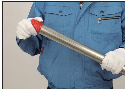
**2.** Entfernen Sie Grate mit einer Reibahle, Sandpapier und einer Schleifmaschine vorsichtig von den innen und außen abgefasen Oberflächen.
