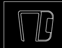
**Junta magnética plana 90° para fijo lateral | 6/8 mm**
