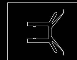
**Junta estanquedad vidrio pivote giro 6 mm**
