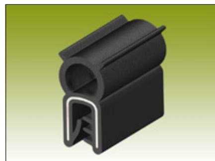
Selbstklebende Kantenschutz-Dichtprofile (Co-Extrusionsprofile) mit Klemmbereich aus Weichgummi EPDM, eingebettetem Stahl- oder Drahtklemmband und Lippe oder Hohlkammer aus Moosgummi EPDM.
