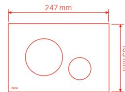
Abmessung aller Betätigungsplatten
