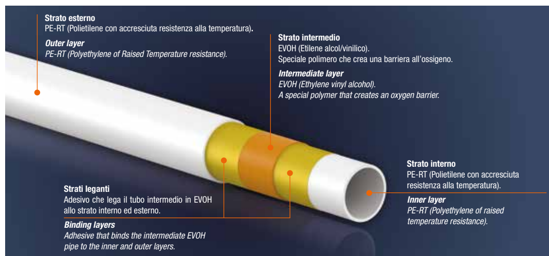
Stratigrafia tubo polipert Polipert pipe stratigraphy
