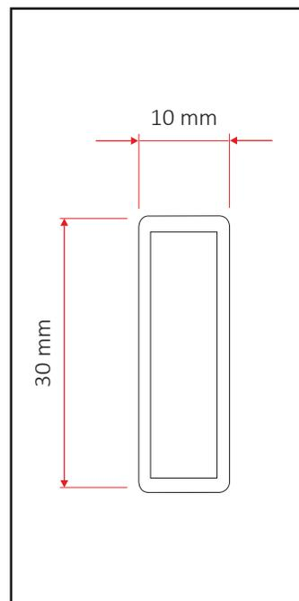
Fuß mit zentralem Rohr, für die Zusammensetzung der Standkonsole, mit rechteckigem Rohr Modell **QT**.
