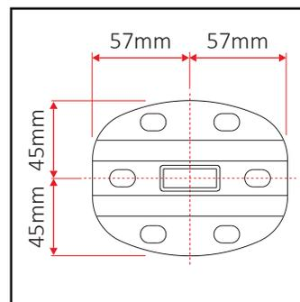
Fuß mit versetztem Rohr, für die Zusammensetzung der Standkonsole, mit rechteckigem Rohr Modell **QT**.
