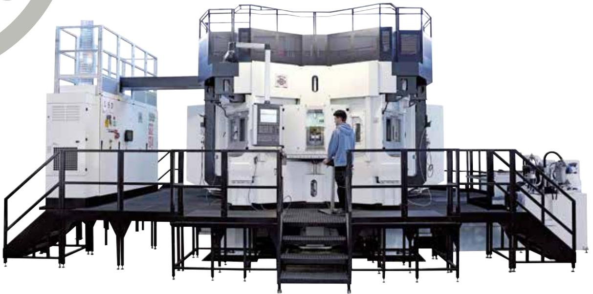
Unser Maschinenpark ist stets auf dem neuesten Stand und umfasst die modernsten Bearbeitungszentren und Drehbänke. Für jede Anforderung haben wir die passende Maschine zur Verfügung. Unter anderem nutzen wir CNC-gesteuerte, flexible Schalttrommelmaschinen mit 8 Einheiten, 24 Spindeln und über 80 kontrollierten Achsen sowie integrierte Verbindungssysteme für die industrielle Datenkommunikation 4.0.
