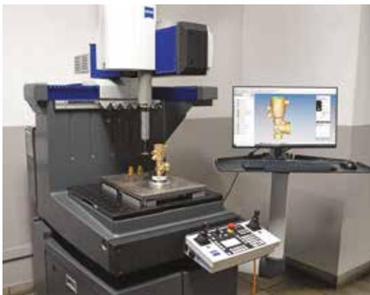
Wir setzen auf höchste Präzision bei der Vermessung dank ZEISS taktilen Einzelpunktmessgeräten.
