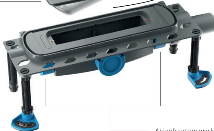
Ablaufstutzen werkzeuglos dreiseitig positionierbar, bewegliches Kugelgelenk zum spannungsfreien Anschluss an die Abwasserleitung
