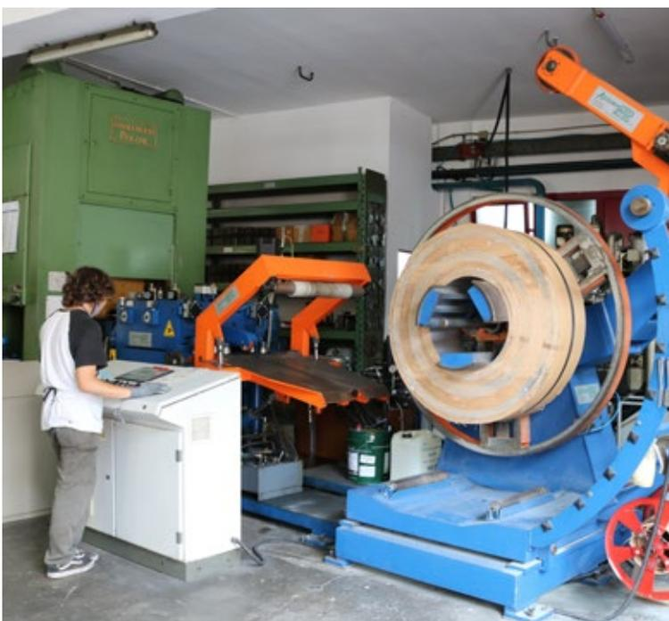
La tranciatura è la prima fase di lavorazione; si parte da una bobina di acciaio dello spessore della posata richiesta. Vantiamo macchinari potenti in grado di tranciare lo spessore di 5mm. In contemporanea viene stampato anche il logo Salvinelli sul retro del manico della posata.
